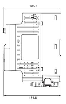
●3G3JZ-AB015 ~ AB022(1.5 ~ 2.2kW)单相AC200V输入 3G3JZ-A2022 ~ A2037(2.2 ~ 3.7kW)3相AC200V输入 3G3JZ-A4022 ~ A4037(2.2 ~ 3.7kW)3相AC400V输入
