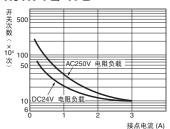
$\frac{DC125V\cos\phi = 1$ 时0.5A max. 可开关(寿命10万次)}{L/R = 7ms时0.2A max.可开关(寿命10万次)
