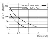
DC125V cosφ = 1时0.5A max. 可开关 (寿命10万次) L/R = 7ms时0.2A max.可开关 (寿命10万次)
