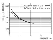
DC125V cosφ = 1时0.6A max. 可开关 (寿命10万次) L/R = 7ms时0.2A max.可开关(寿命10万次)
